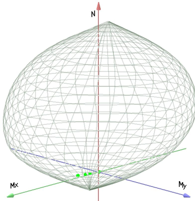
**Caratteristiche limite della sezione:**
