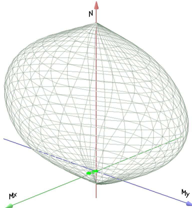
**Caratteristiche limite della sezione:**
