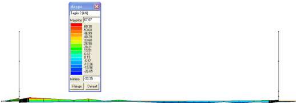
FIGURA 11.4-2 - INVILUPPO SLU/SLV MOMENTO FLETTENTE PIEDRITTI
