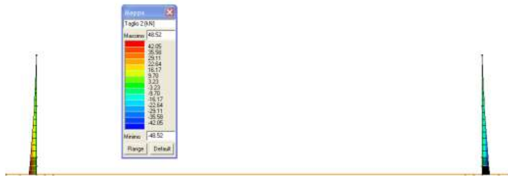
FIGURA 11.4-4 - INVILUPPO TAGLIO SLU/SLV PIEDRITTI
