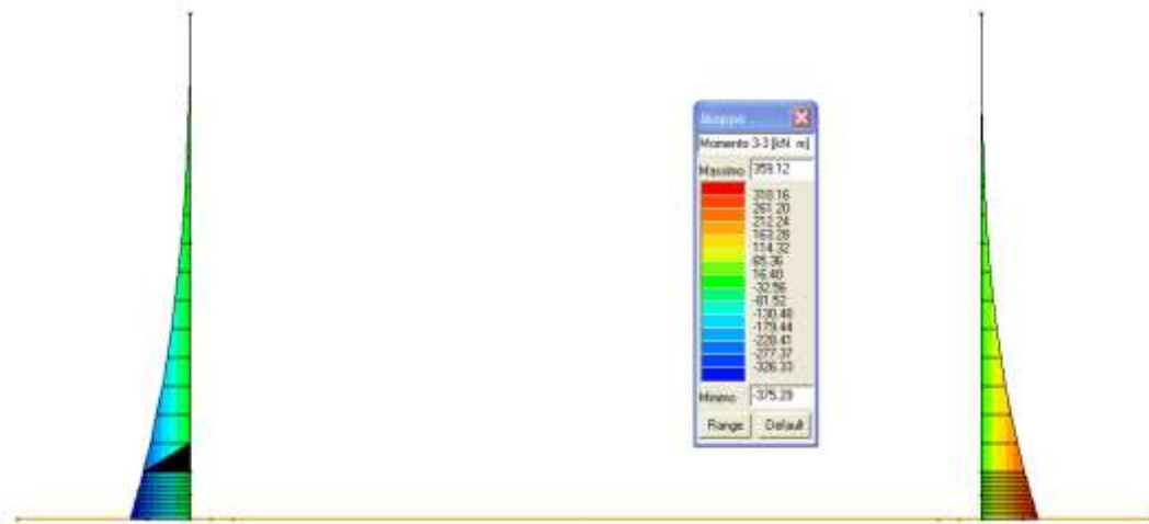
FIGURA 10.4-2 - INVILUPPO SLU/SLV MOMENTO FLETTENTE PIEDRITTI
