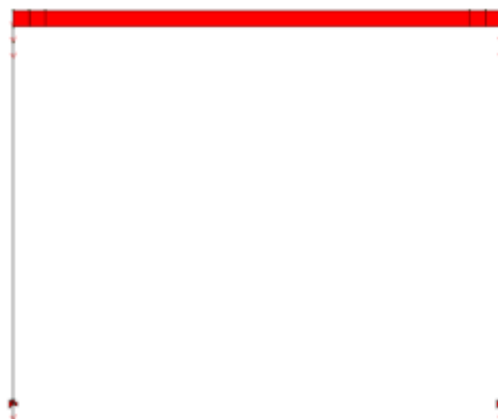
FIGURA 12.2-1 - PESO PROPRIO DELLA STRUTTURA (CARICO AUTOMATICO, CDC 1)
