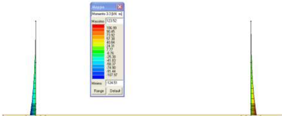
FIGURA 11.4-2 - INVILUPPO SLU/SLV MOMENTO FLETTENTE PIEDRITTI
