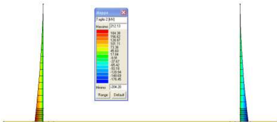
FIGURA 10.4-4 - INVILUPPO TAGLIO SLU/SLV PIEDRITTI
