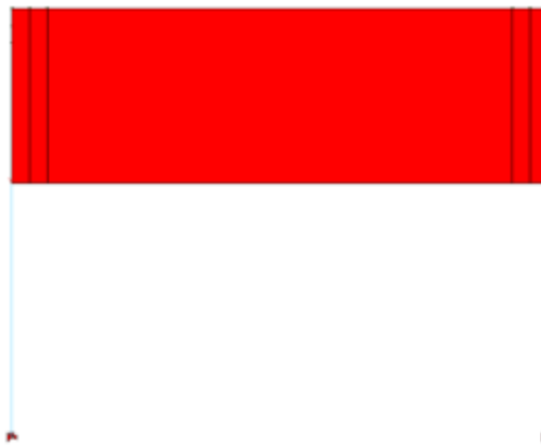
FIGURA 12.2-2 - SPINTA A RIPOSO DELLE TERRE SUL PIEDRITTO SINISTRO (CDC 3)
