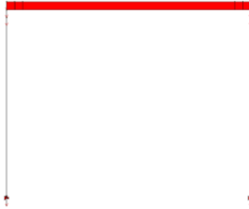
FIGURA 12.2-1 - PESO PROPRIO DELLA STRUTTURA (CARICO AUTOMATICO, CDC 1)
