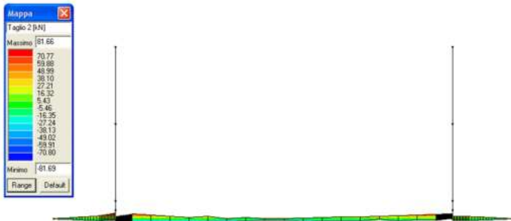
FIGURA 11.4-3 - INVILUPPO TAGLIO SLU/SLV SOLETTA SOLETTA DI FONDAZIONE
