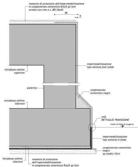
DETTAGLIO IMPERMEABILIZZAZIONE SCATOLARE
