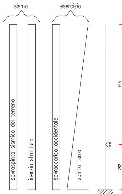
Lo schema statico della struttura e la relativa numerazione dei nodi e degli elementi beam, sono riportati di seguito:
