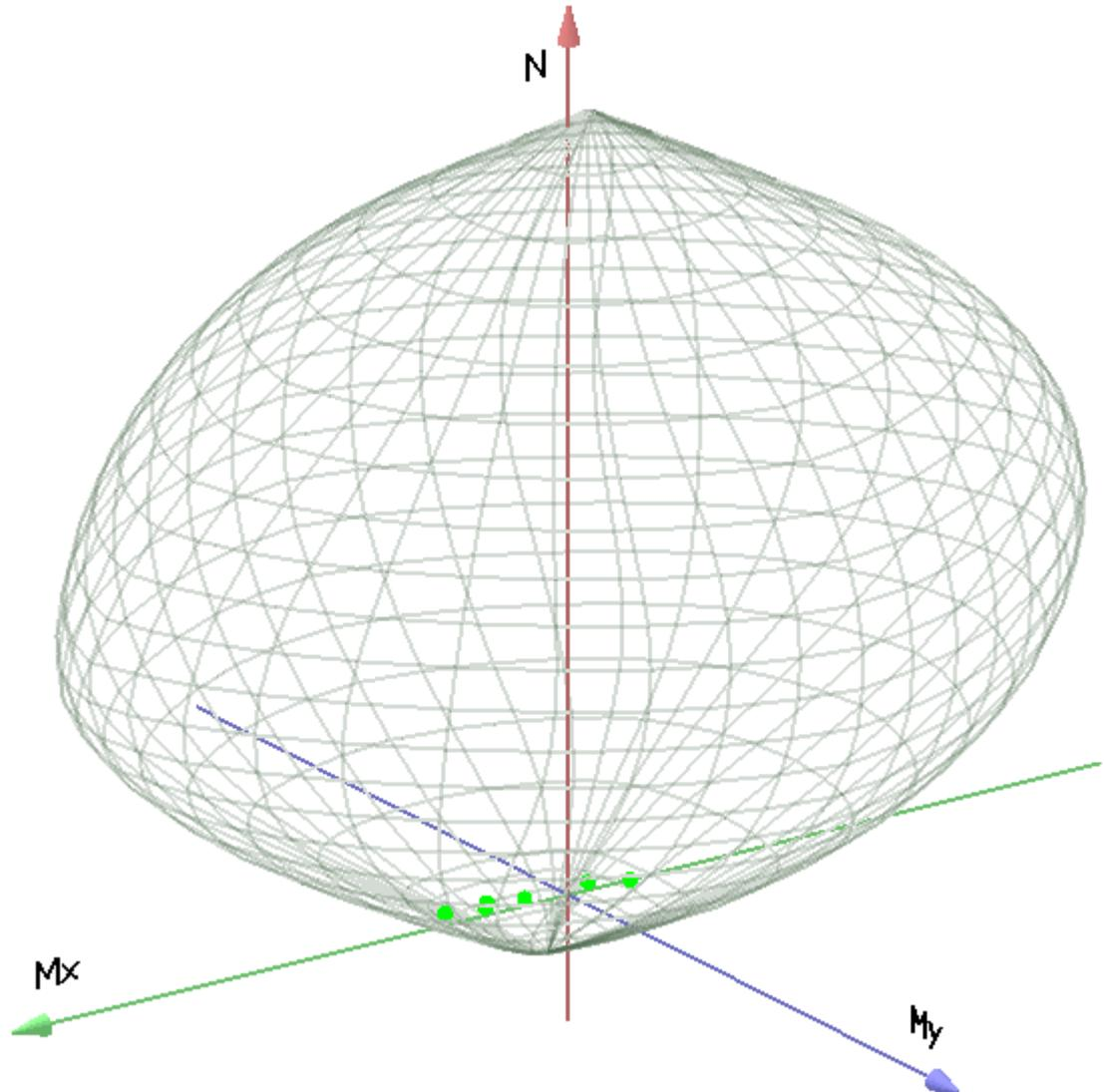
**Caratteristiche limite della sezione:**
