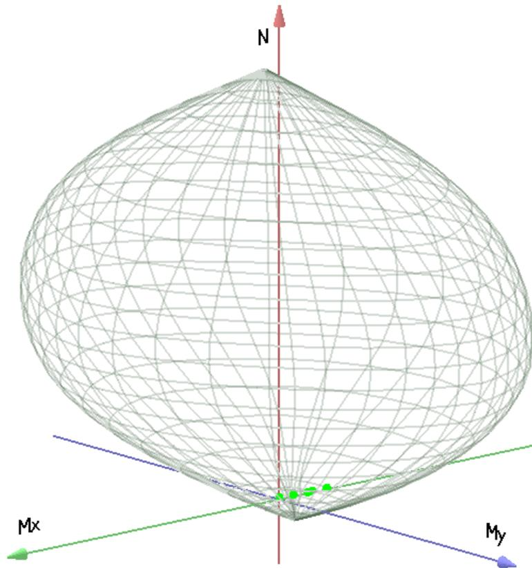
**Caratteristiche limite della sezione:**
