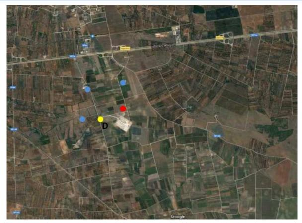
Nell'ortofoto sopra riportata sono ubicate la sottostazione di trasformazione MT/AT (pallino rosso) nel Comune di Erchie, il punto di misurazione di Leq(A) rumore ambientale (pallino giallo) e i ricettori più vicini posti a distanza comunque superiore a 400 metri.
