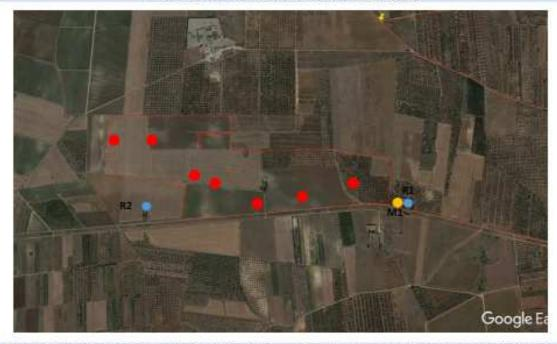
Area ERV2: Indicazione dei ricettori (pallini azzurri), delle cabine inverter / trasformazione BT/MT (pallini rossi), dei punti di misurazione di Leq(A) (pallini gialli)
