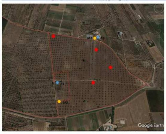
AREA ERV\_3 e ERV\_4: Indicazione dei ricettori (pallini azzurri), delle cabine inverter / trasformazione BT/MT (pallini rossi), dei punti di misurazione di Leq(A) (pallini gialli)
