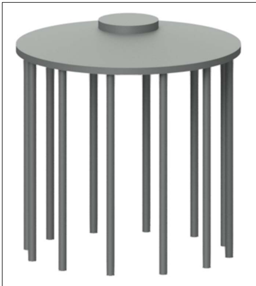
Figura 1: vista tridimensionale della fondazione dell'aerogeneratore
