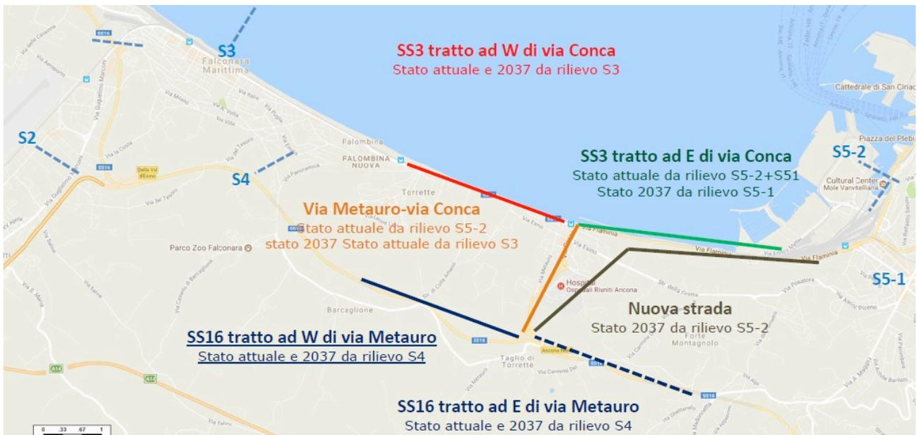
Figura 3.f – Schema di utilizzo dei rilievi stradali riassunti nell'analisi trasportistica (n. T00SG00AMBRE01 della rev. B del 21/05/2018) per l'elaborazione dei flussi veicolari orari medi necessari all'analisi acustica suddivisi in TR diurni TR Notturni.
