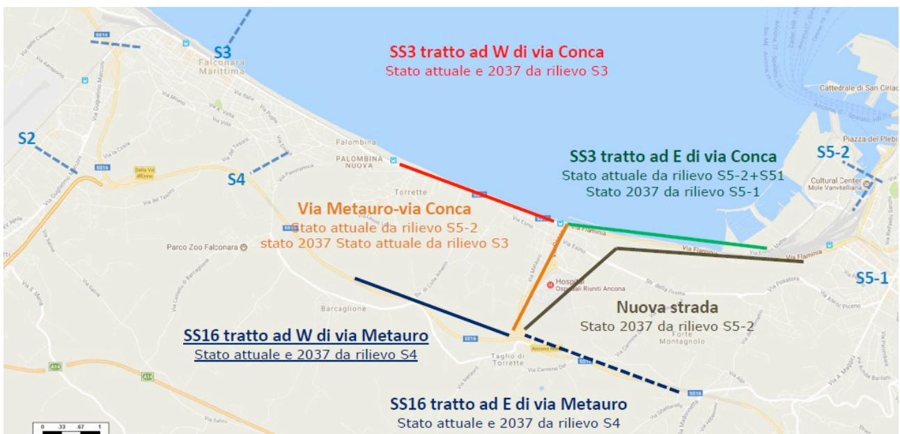
Figura 4.a – Schema di utilizzo dei rilievi stradali riassunti nell'analisi trasportistica (n. T00SG00AMBRE01 della rev. B del 21/05/2018) per l'elaborazione dei flussi veicolari orari medi necessari all'analisi acustica suddivisi in TR diurni TR Notturmi.
