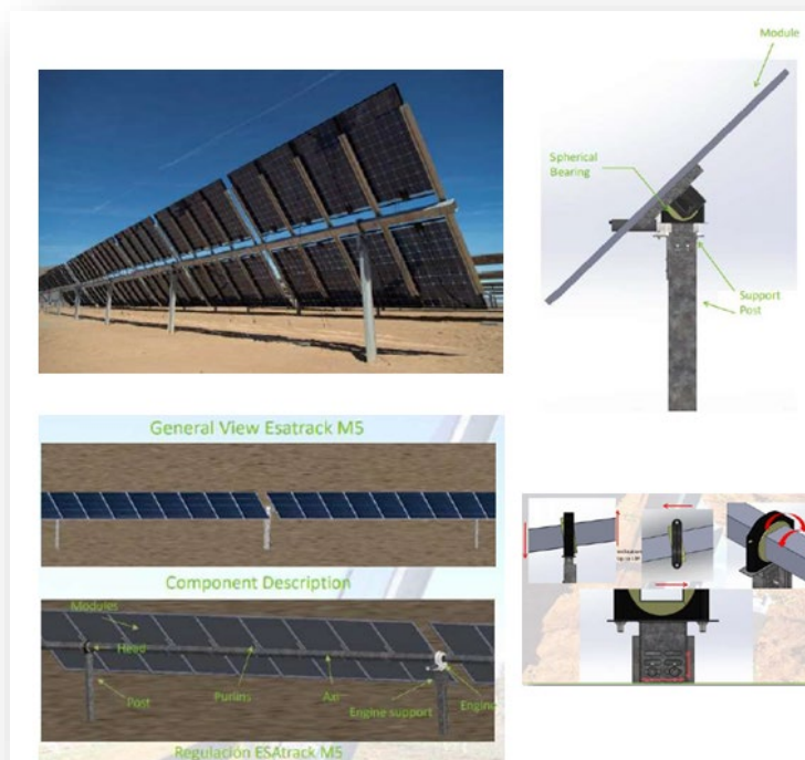
Figura 7 - Strutture di sostegno e sistema di inseguimento solare
