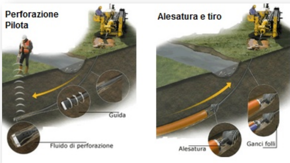
Figura 28 - tecnologia di trivellazione orizzontale controllata (TOC)
