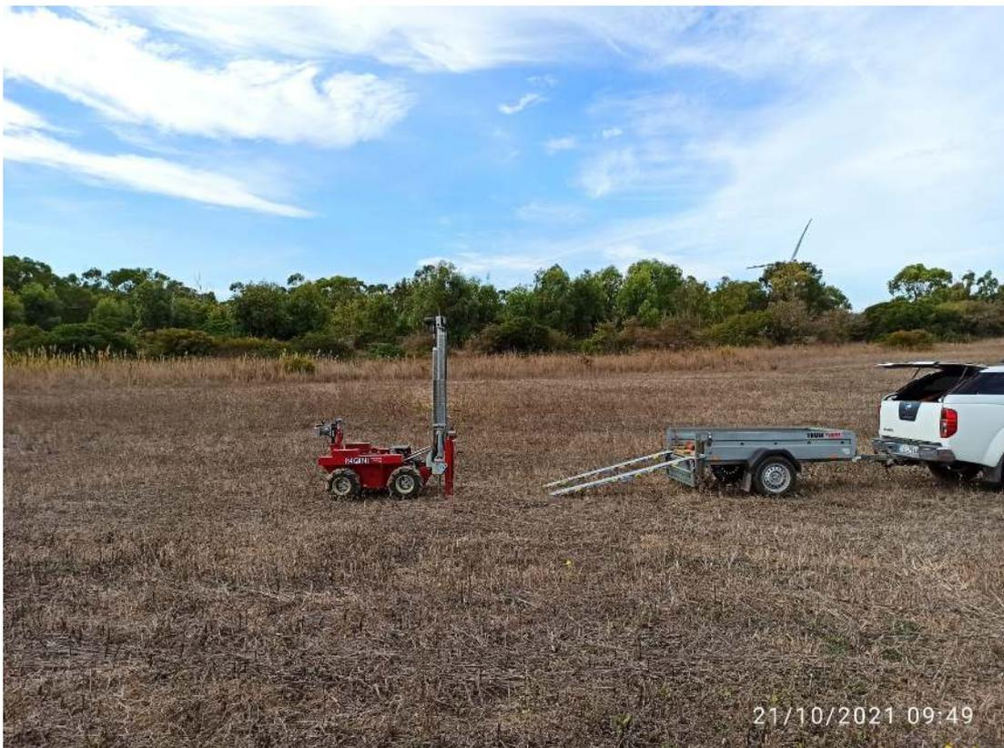
**Fig.36 particolare posizionamento prova penetrometrica DPM6 campo fotovoltaico "Area 4".**
