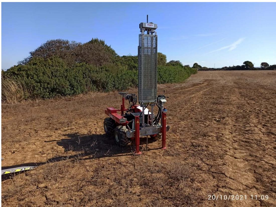
**Fig.34 particolare posizionamento prova penetrometrica DPM3 campo fotovoltaico "Area 1".**
