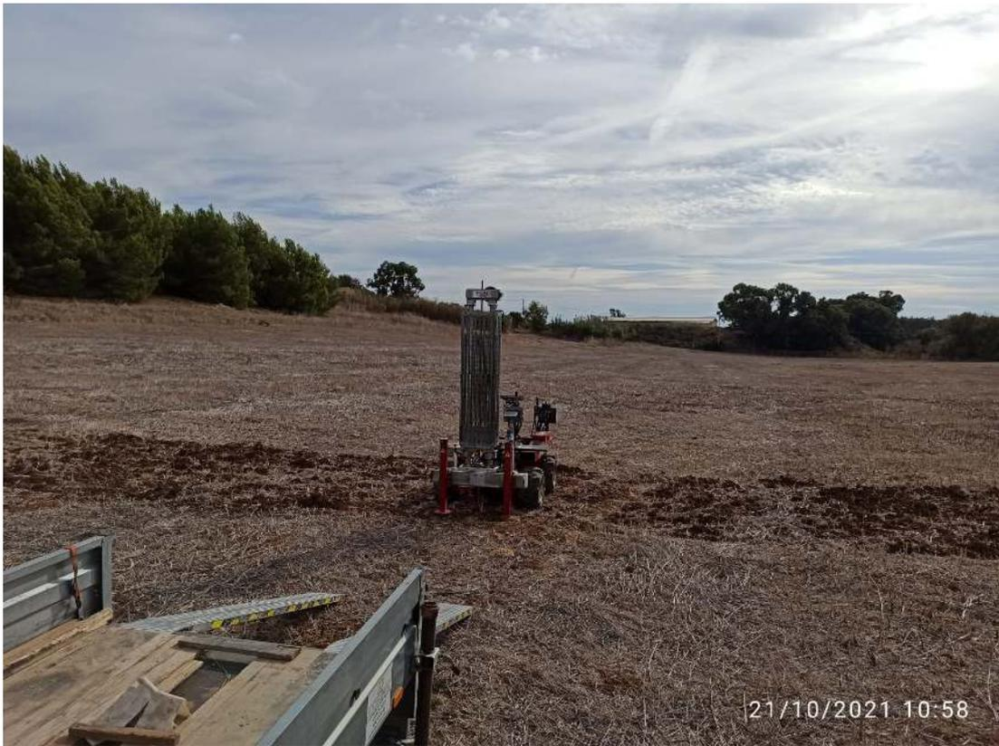
**Fig.37 particolare posizionamento prova penetrometrica DPM7 campo fotovoltaico "Area 4".**
