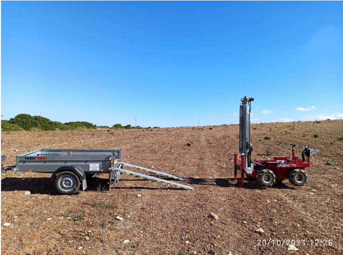
**Fig.35 particolare posizionamento prova penetrometrica DPM4 campo fotovoltaico "Area 3".**
