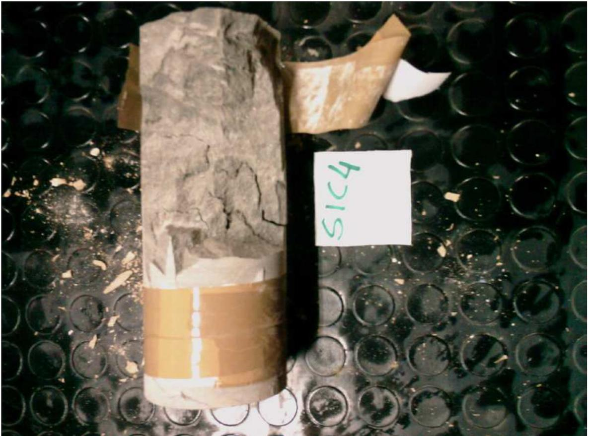
Foto n° 13 – Particolare prova di schiacciamento campione S1C4.
