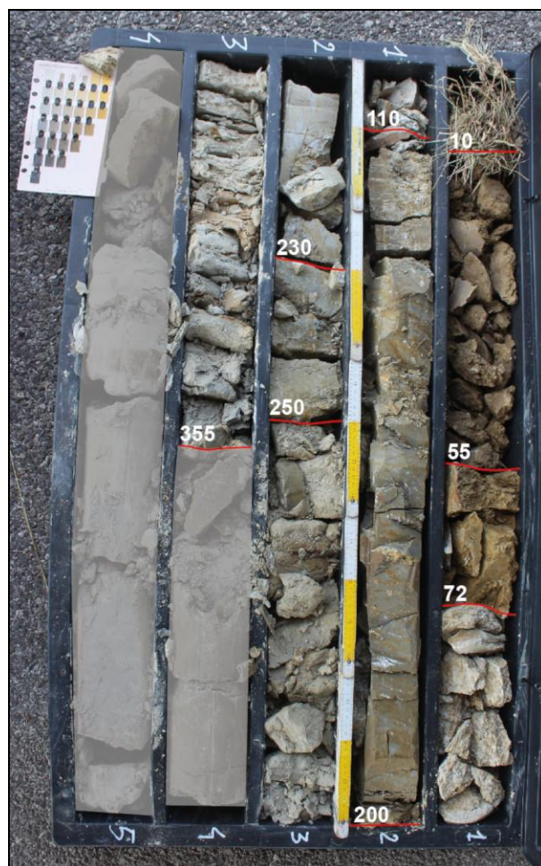
Figura 17 – Il sondaggio a carotaggio continuo S1.
