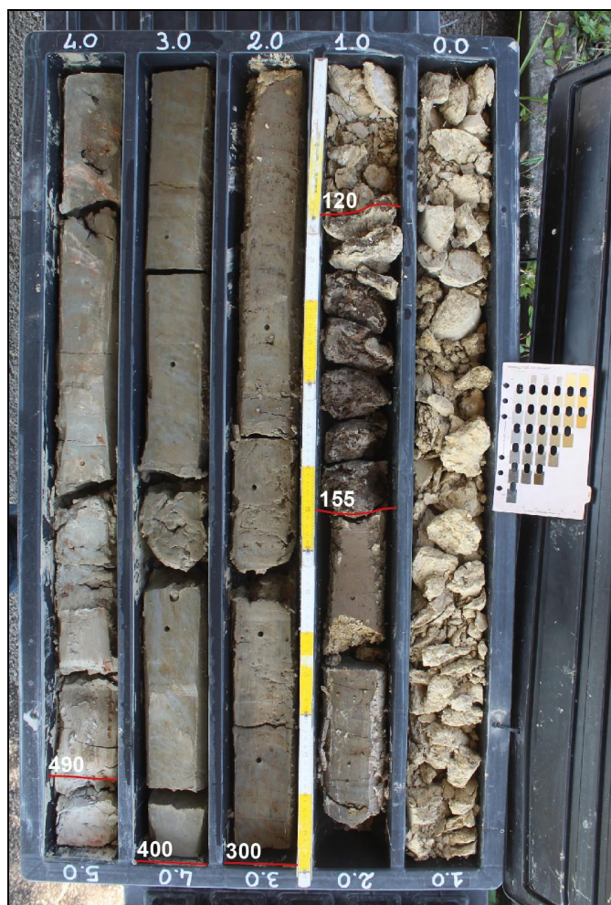
Figura 15 – Il sondaggio a carotaggio continuo SD1.
