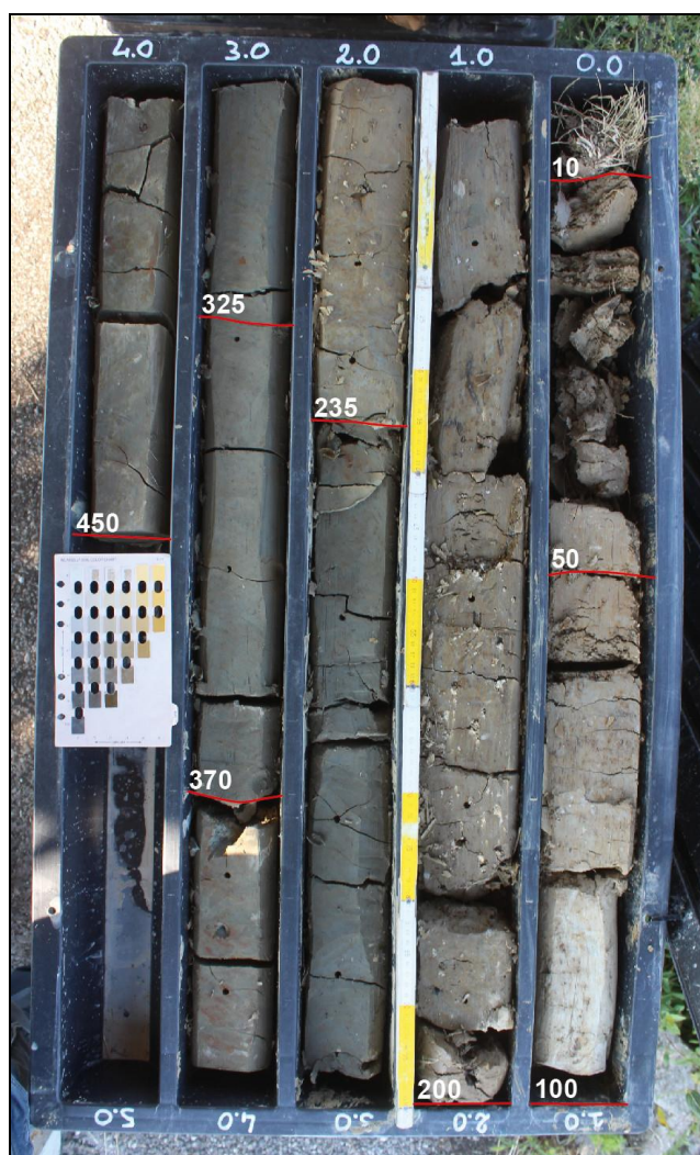
Figura 16 – Il sondaggio a carotaggio continuo SD2.
