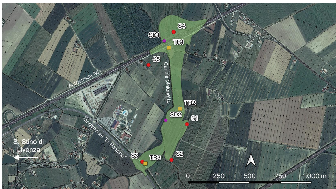
Figura 1 – Posizionamento dell'area interessata dalle opere in progetto con indicazione dei sondaggi a carotaggio continuo di 4 m di profondità massima (cerchi rossi), dei sondaggi a carotaggio continuo di 45 m di profondità massima (pentagoni viola) e delle trincee esplorative (quadrati gialli).
