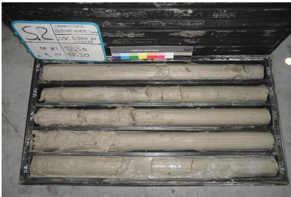
Sondaggio S2 - da -12,50 a -17,50 metri
