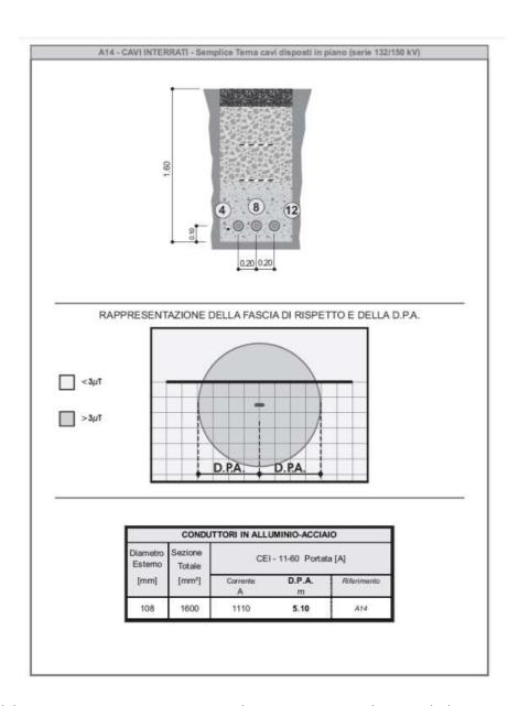
Il diagramma del campo magnetico ottenuto per la sottostazione e il cavo ad alta tensione utilizzando lo strumento di calcolo è mostrato qui sotto. Mostra i calcoli che sono stati eseguiti e il diagramma risultante dove si può vedere che è all'interno degli standard.
