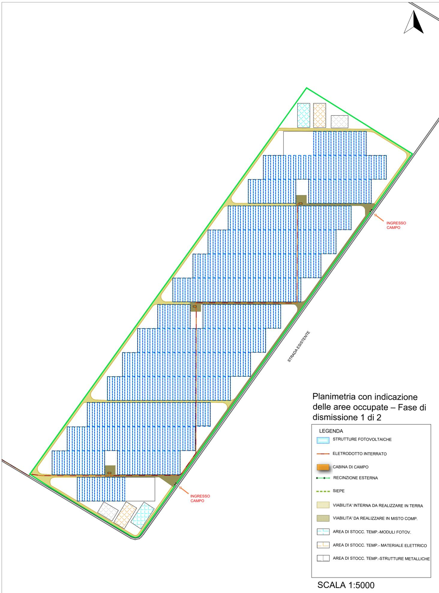
Planimetria con indicazione delle aree occupate – Fase di dismissione 1 di 2
