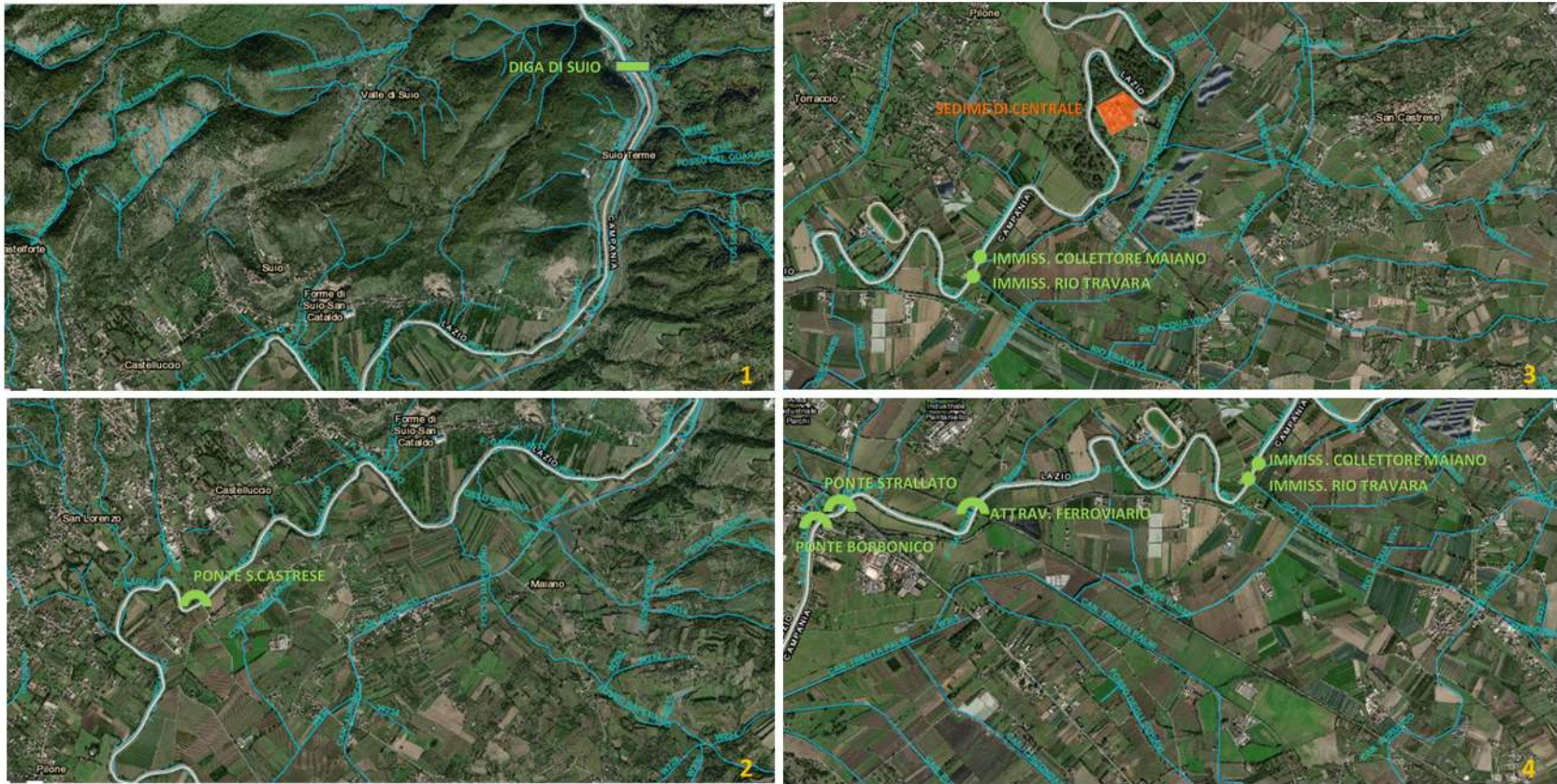
Figura 2-4 – Dettaglio del tratto di interesse con evidenziati maggiori punti di interferenza tra le infrastrutture ed il fiume ai fini del suo assetto idraulico
