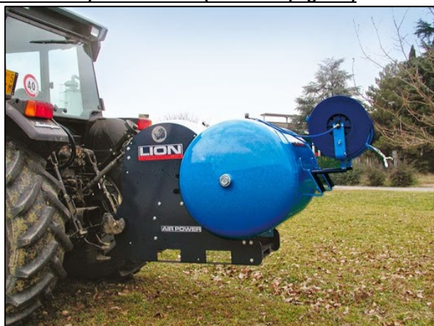
Figura 6.11: Compressore PTO per il funzionamento di strumenti pneumatici per l'arboricoltura e scuotitore motorizzato per la raccolta (Foto: Campagnola)
