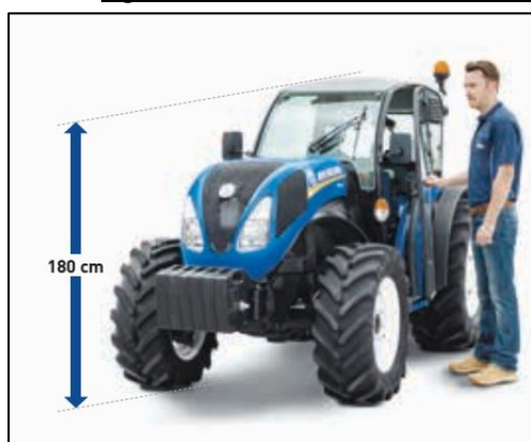
Figura 7.1: Dimensioni caratteristiche di un trattore da frutteto con cabina ribassata (Fonte: CNH)
