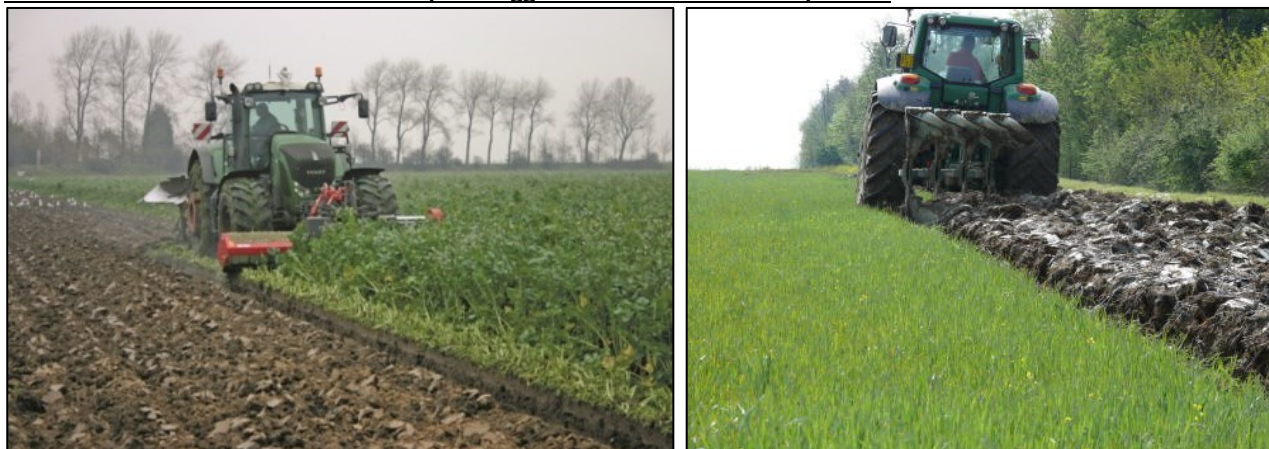
Fig. 6.6: Esempio di pratica del sovescio in pieno campo. Si noti, nell’immagine a sinistra, l’impiego di una trincia frontale montata sulla stessa trattore per alleggerire il carico sull’aratro portato
