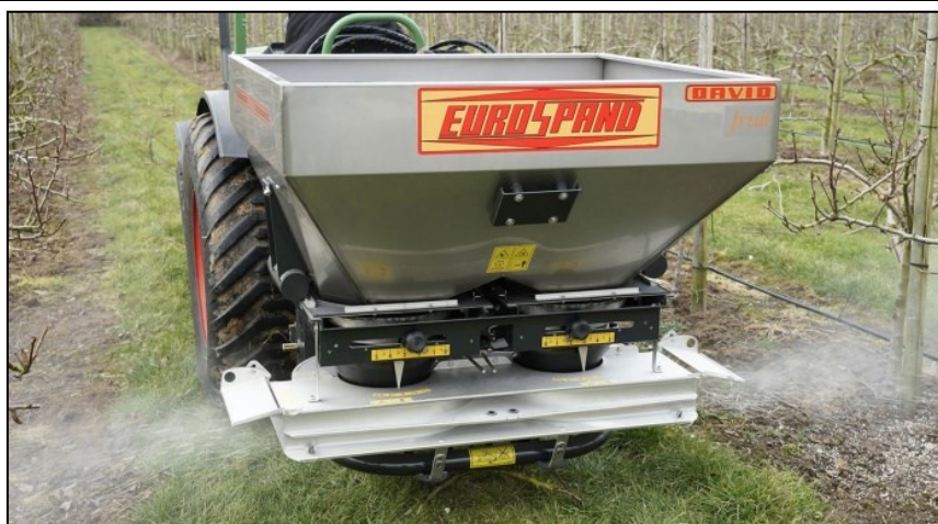
Figura 6.13: esempio di spandiconcime localizzato mono/bilaterale per frutteti (Foto: EuroSpand)
