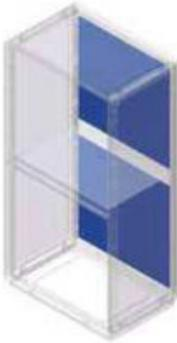
Applicabili sulla parete di fondo dell'armadio mediante inserti speciali filettati muniti di prigioniero M6x20 oppure in abbinamento a montanti portapparecchiature. Viti per fissaggio piastra a corredo dell'armadio.
