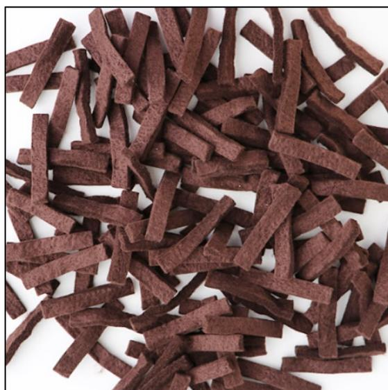
*Figura 3.3 - Esempio di ritentori idrici di geotessuto.*
