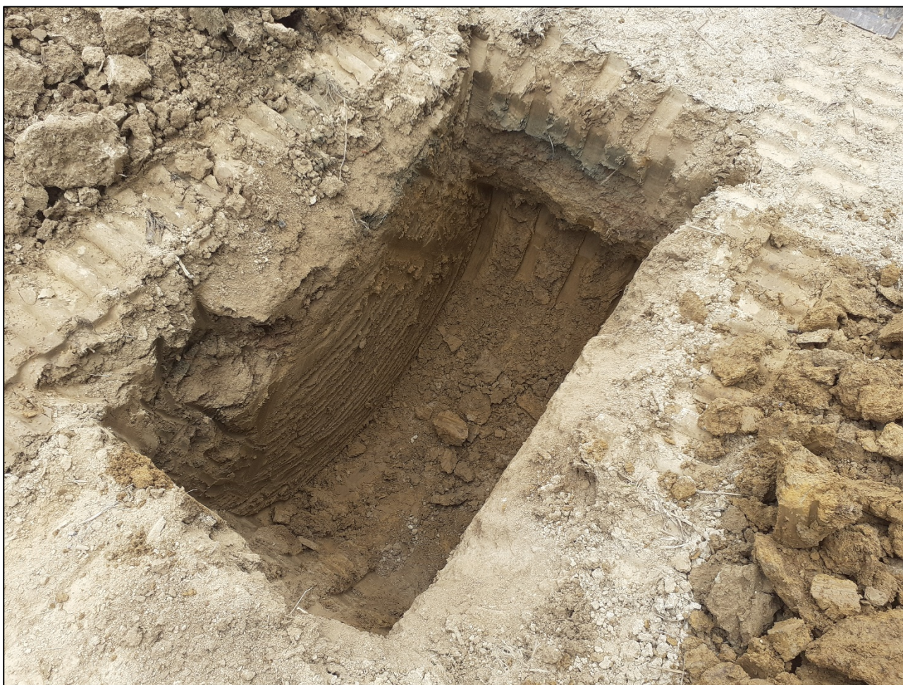
Figura 2.4: profilo di suolo nell'area di studio (maggio 2020). Le litologie sono caratterizzate da depositi fini.
