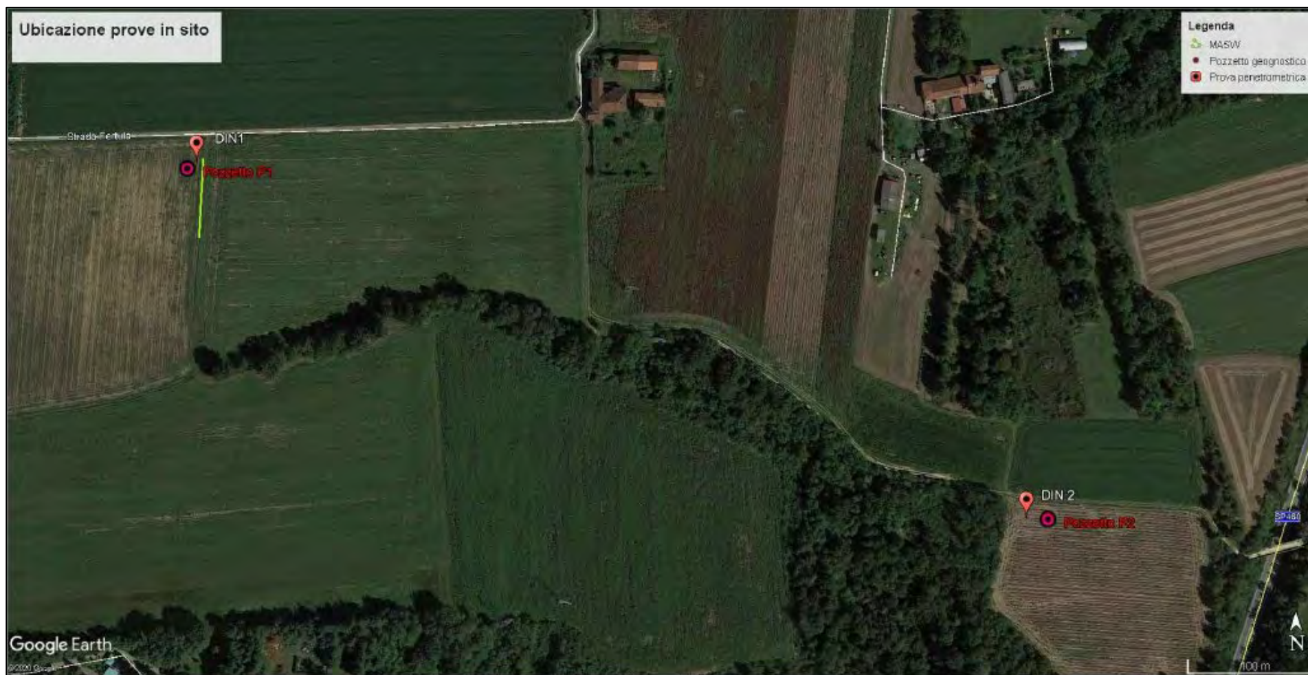
Figura 5.12: ubicazione pozzetti geognostici.
