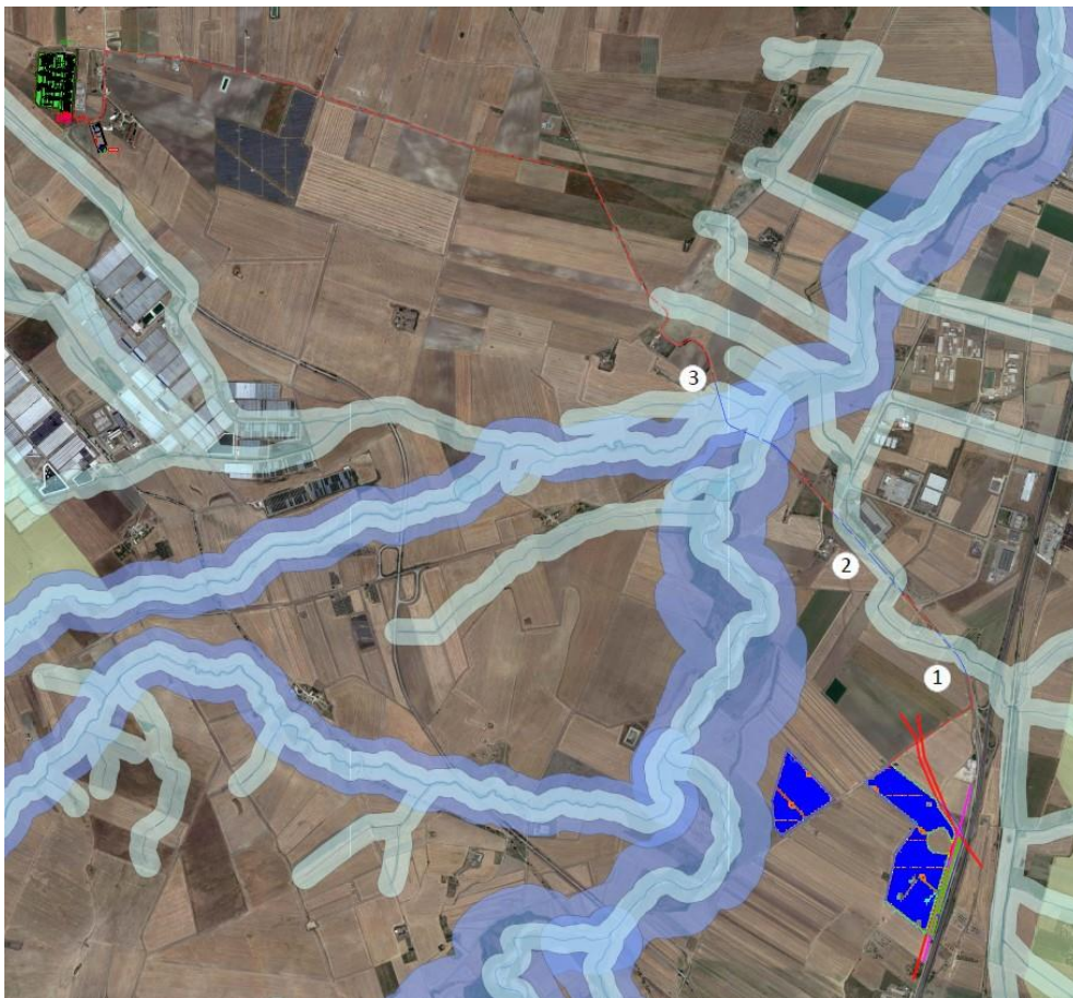
Intersezioni cavidotto con reticolo
