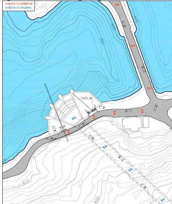
Mentre proseguiranno gli scavi in avanzamento a piena sezione, a partire dall'imbocco (progr. 0) sarà realizzata l'armatura provvisoria dello scavo mediante centine almeno sino alla progr. 12 m; l'eventuale prosecuzione dell'armatura con centine verrà decisa dalla D.L. sulla base delle misure di convergenza e delle caratteristiche della roccia.
