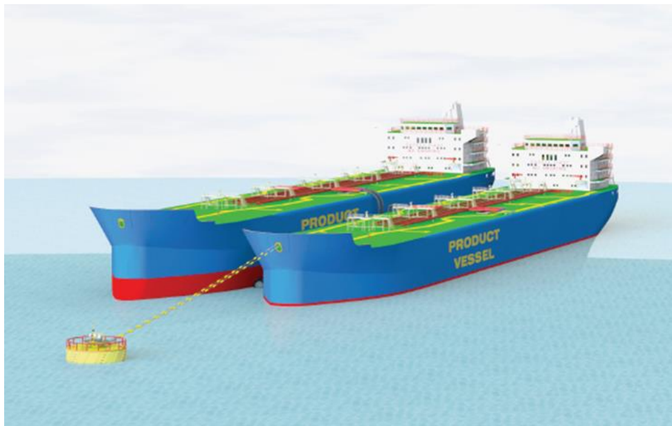
Figura 4.4: Layout del sistema "STS Mooring Buoy" proprietà di Orwell Offshore"
