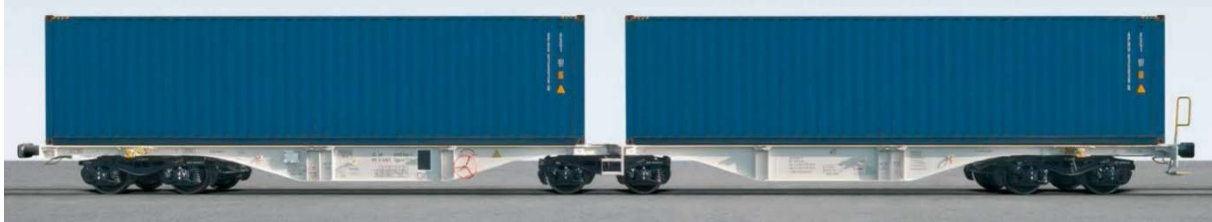
Figura 5.4: Carri tipo SGRS per il trasporto di due container da 40 piedi
