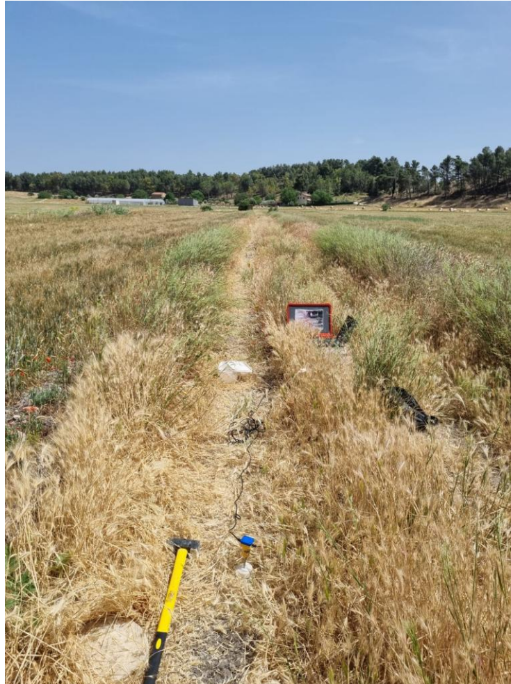
Esecuzione della prova MASW
