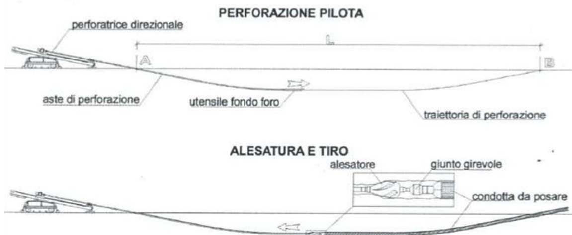
Schematico di Trivellazione Orizzontale Controllata
