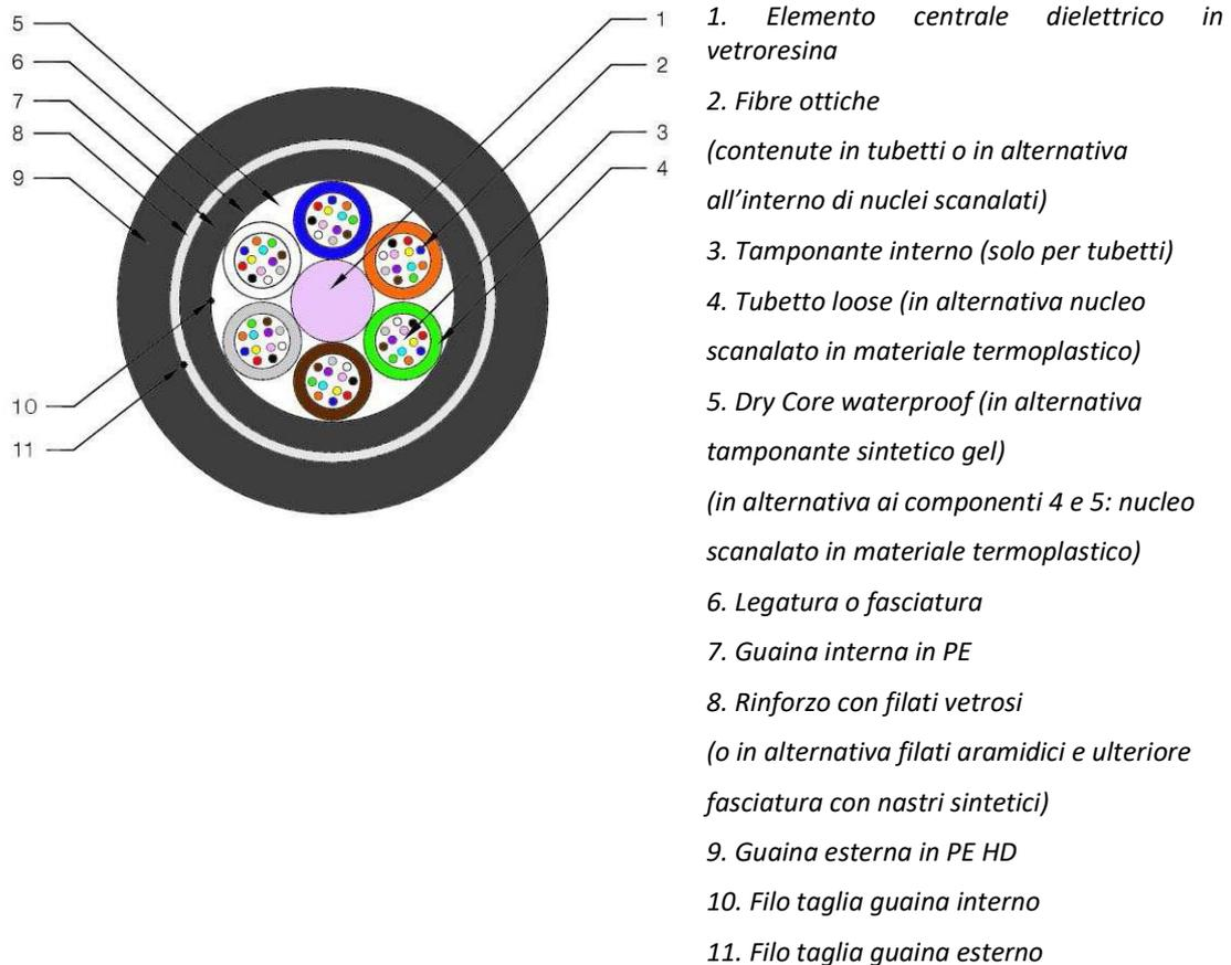
La figura viene riportata solo a titolo indicativo e si riferisce alla disposizione delle fibre ottiche in tubetti. Nelle strutture a 48 fibre, qui utilizzate, al posto dei tubetti sono presenti 2 riempitivi dielettrici. Le fibre sono di tipo monomodali. La sezione del cavo è una rappresentazione non è in scala.
