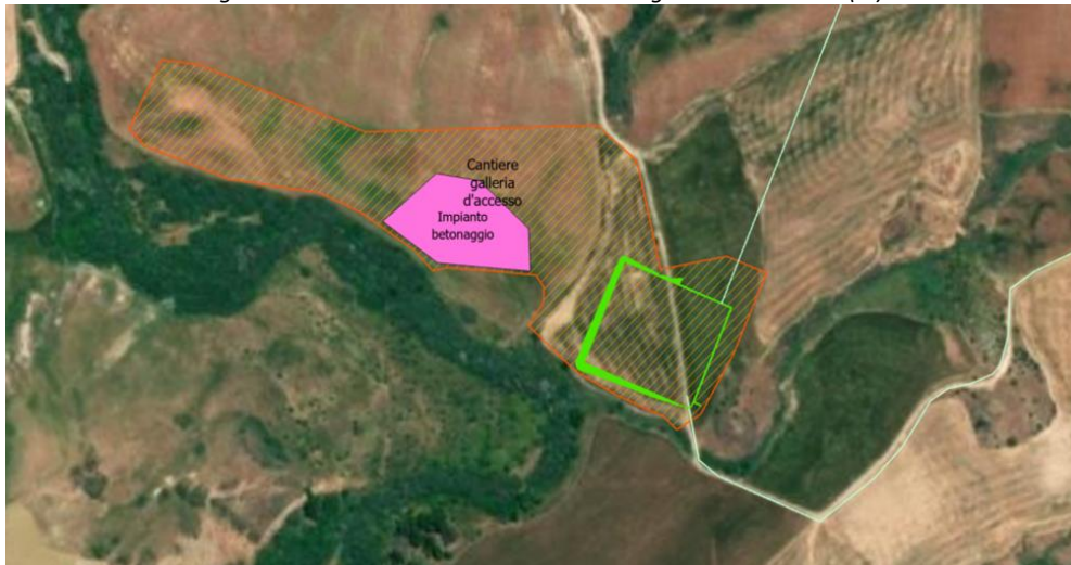
Figura 3 – PLANIMETRIA LAYOUT Cantiere galleria di accesso (CI)
