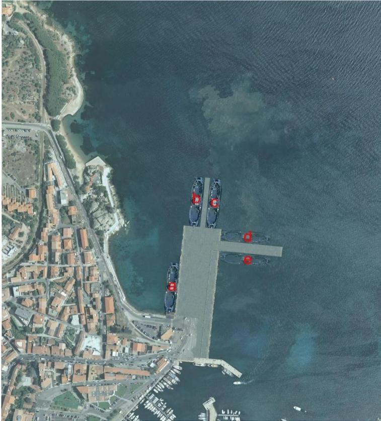
**Figura 5 - complessivo dell'opera con evidenziazione degli accosti per ferry boat**
