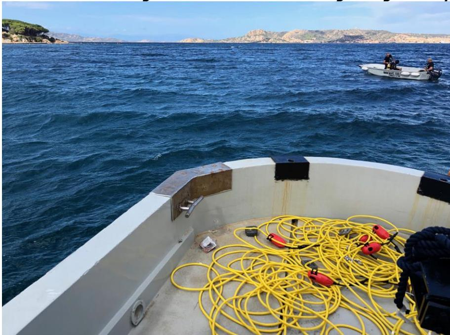
***Catena idrofonica utilizzata in fase di sistemazione sul fondo ad opera di SUB***
