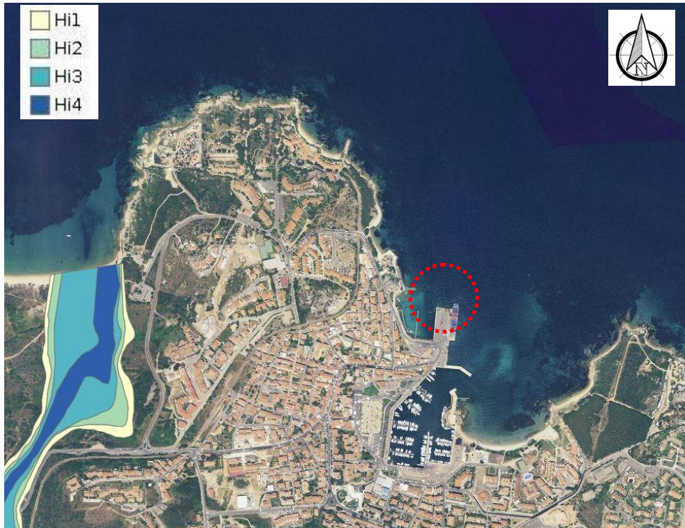
Figura 5-2: Stralcio della cartografia della pericolosità idraulica del PAI (non in scala). In rosso l'area di studio
