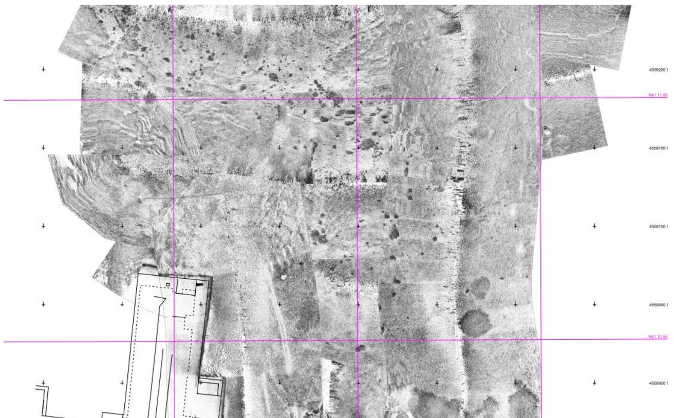
Figura 42: immagine ricavata dal rilievo side scan sonar
