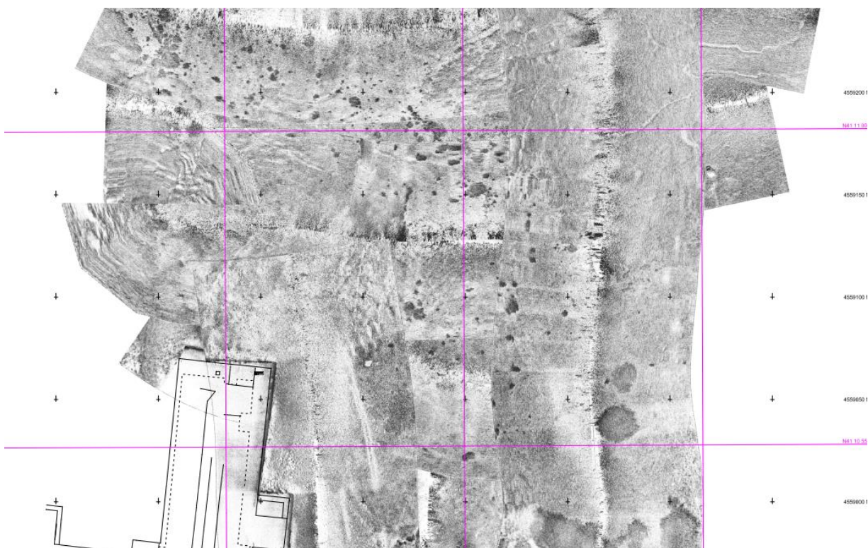
Figura 24: immagine ricavata dal rilievo side scan sonar
