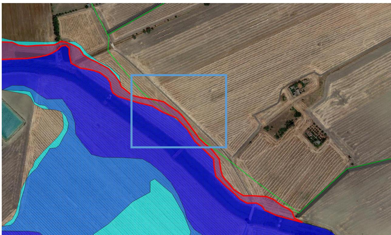
**Figura 9 - possibilità di uscire dalle aree MP-AP del PAI con un leggero spostamento di tracciato**
