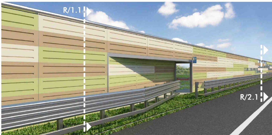
FIGURA 7.4-24 –SCALA DI SICUREZZA IN CORRISPONDENZA DELLE BARRIERE DI PROTEZIONE ACUSTICA: VISTA LATO SORGENTE
