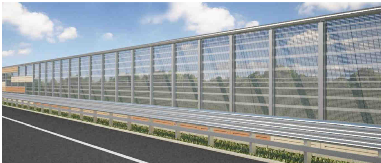
FIGURA 7.4-18 – BARRIERA ACUSTICA FONOIOLANTE TRASPARENTE TIPO 2 – VISTA LATO SORGENTE
