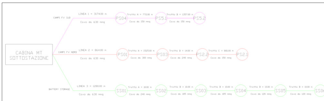
Configurazione campi, linee e rami (tratto da Tavola SCHEMA ELETTRICO UNIFILARE MT)
