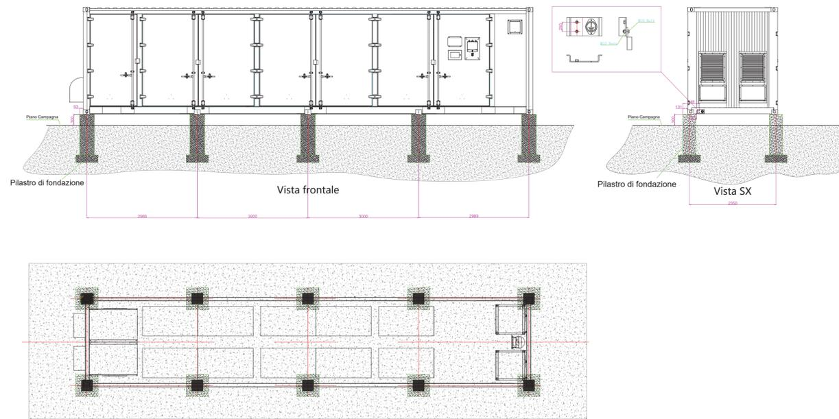
Container batterie sistema di accumulo energia, dimensioni e layout interno
