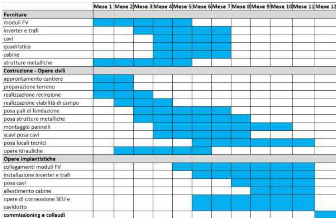
Fig. 13_Cronoprogramma di cantiere
