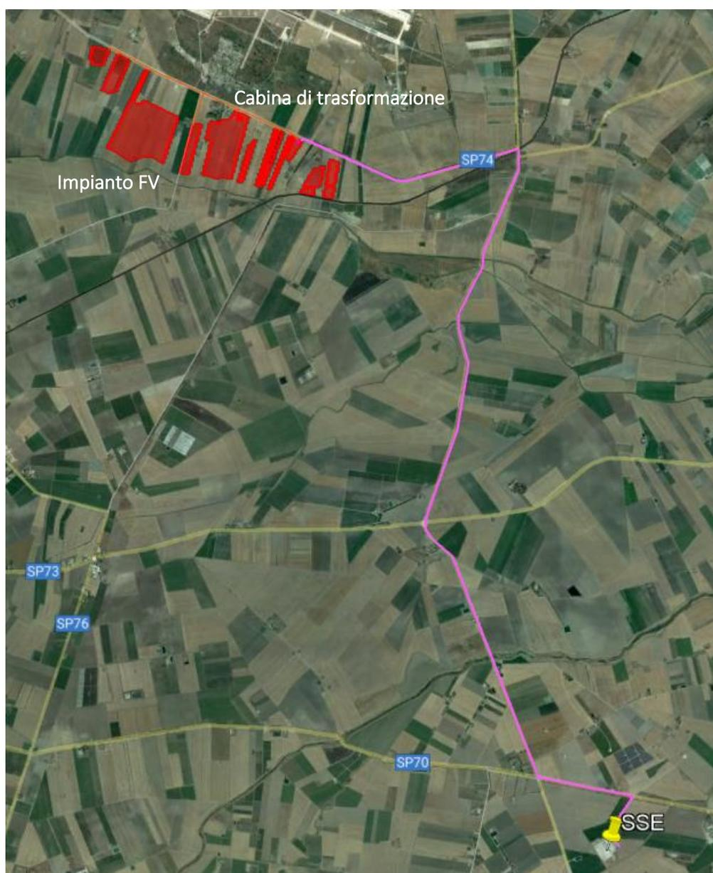
Figura 2.44: In magenta il percorso di connessione dal campo FV alla SSE
