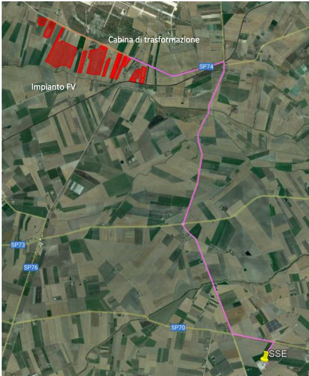
Figura 2.10: In magenta il percorso di connessione dal campo FV alla SSE
