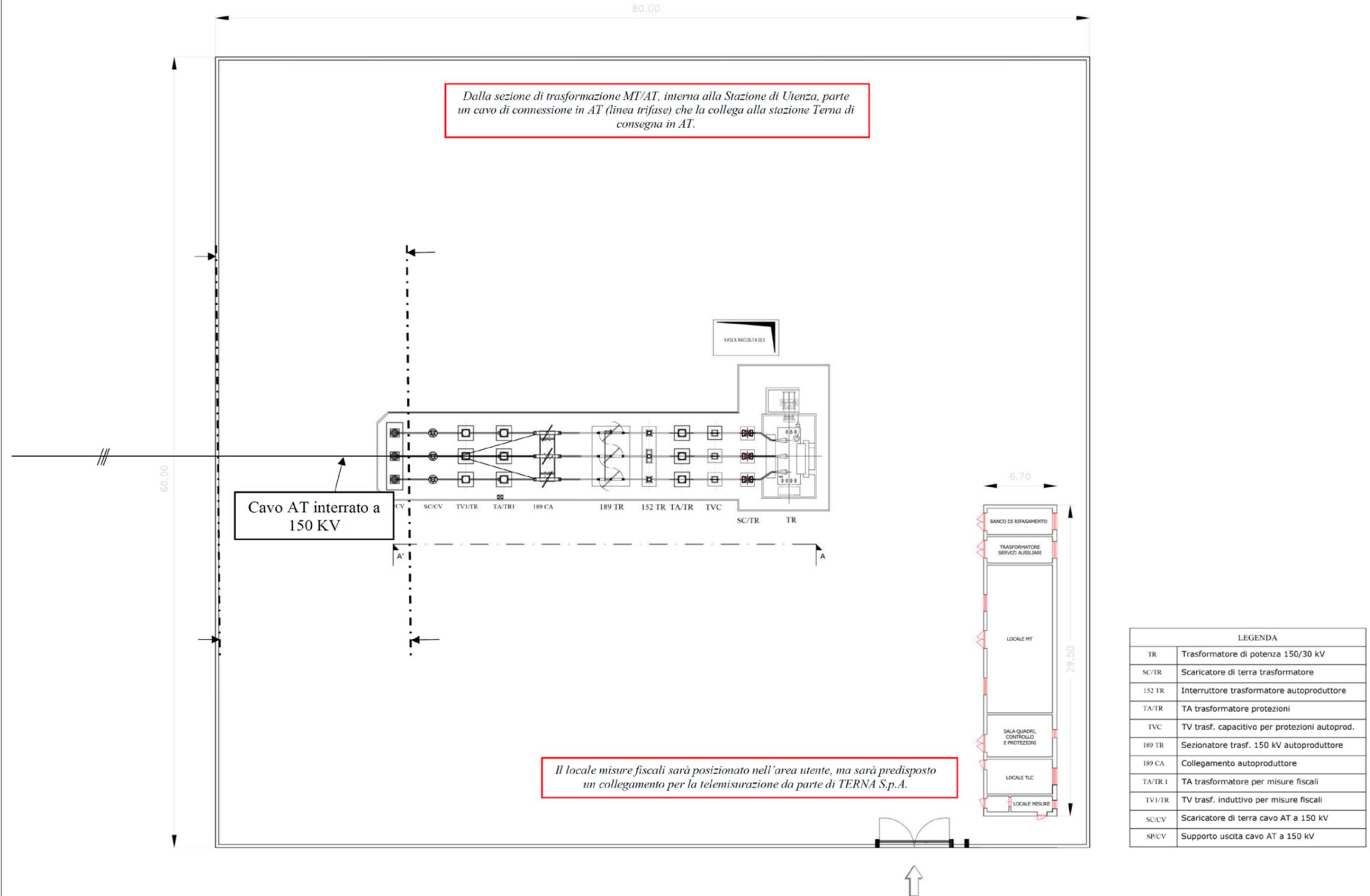
Dalla sezione di trasformazione MT/AT, interna alla Stazione di Utenza, parte un cavo di commessione in AT (linea trifase) che la collega alla stazione Terna di consegna in AT.
