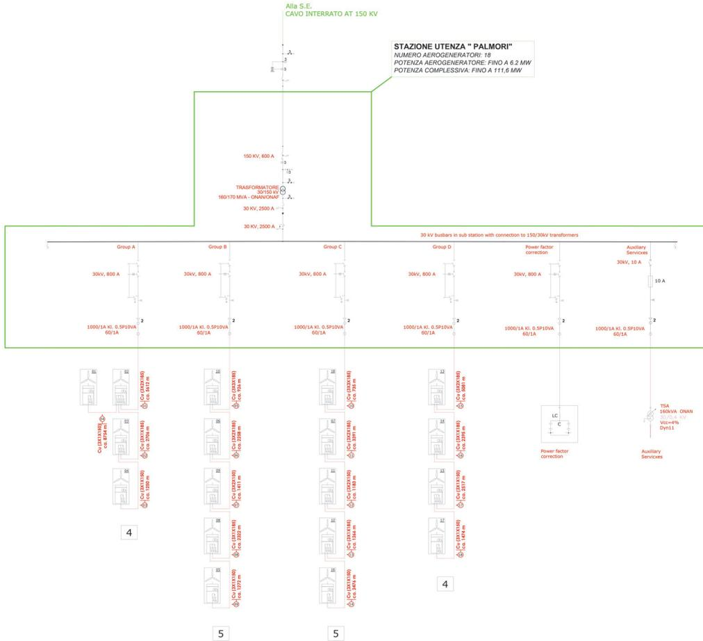
Schema elettrico unifilare (vedi Tavola Tav42“Unifilare opere utente per la connessione”).
