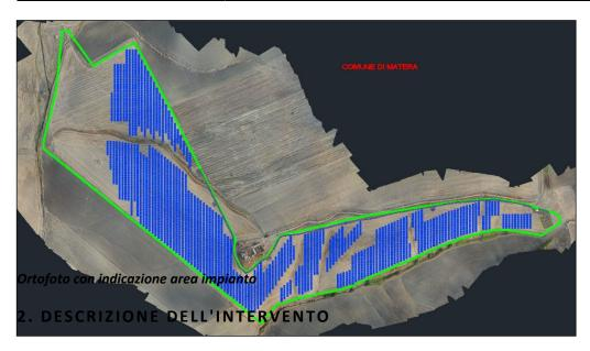
La soluzione proposta consiste nell'installazione di **30.240 moduli** fotovoltaici di tipo monocristallino della potenza di **660 Wp** cad., per una potenza complessiva di **19.958,40 KiloWatt** di picco.
