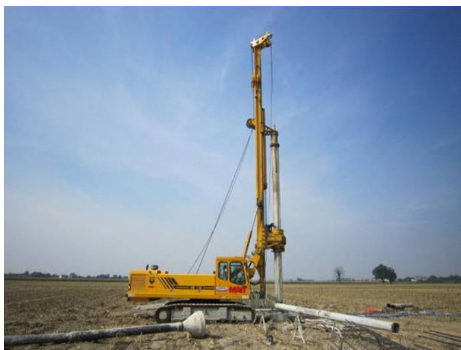
Figura 22: Macchina operatrice per la realizzazione di pali trivellati e fondazione in fase di realizzazione
