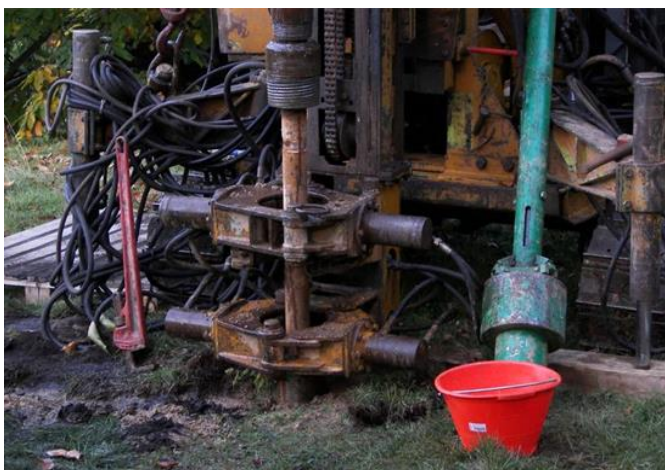
Figura 26: Macchina operatrice per la realizzazione di micropali tubfix. A sinistra sistema di scavo a rotopercussione, a destra sistema di scavo mediante trivella elicoidale.
