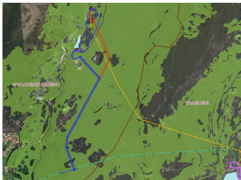
Figura 8: Vincoli D. Lgs 42/2004 e s.m.i., art. 142, lettera g (Fonte: https://siat.provincia.tn.it/ ). E' indicato in blu il tracciato in progetto, in rosso il tracciato dell'alternativa di progetto ed in giallo la linea esistente da demolire
