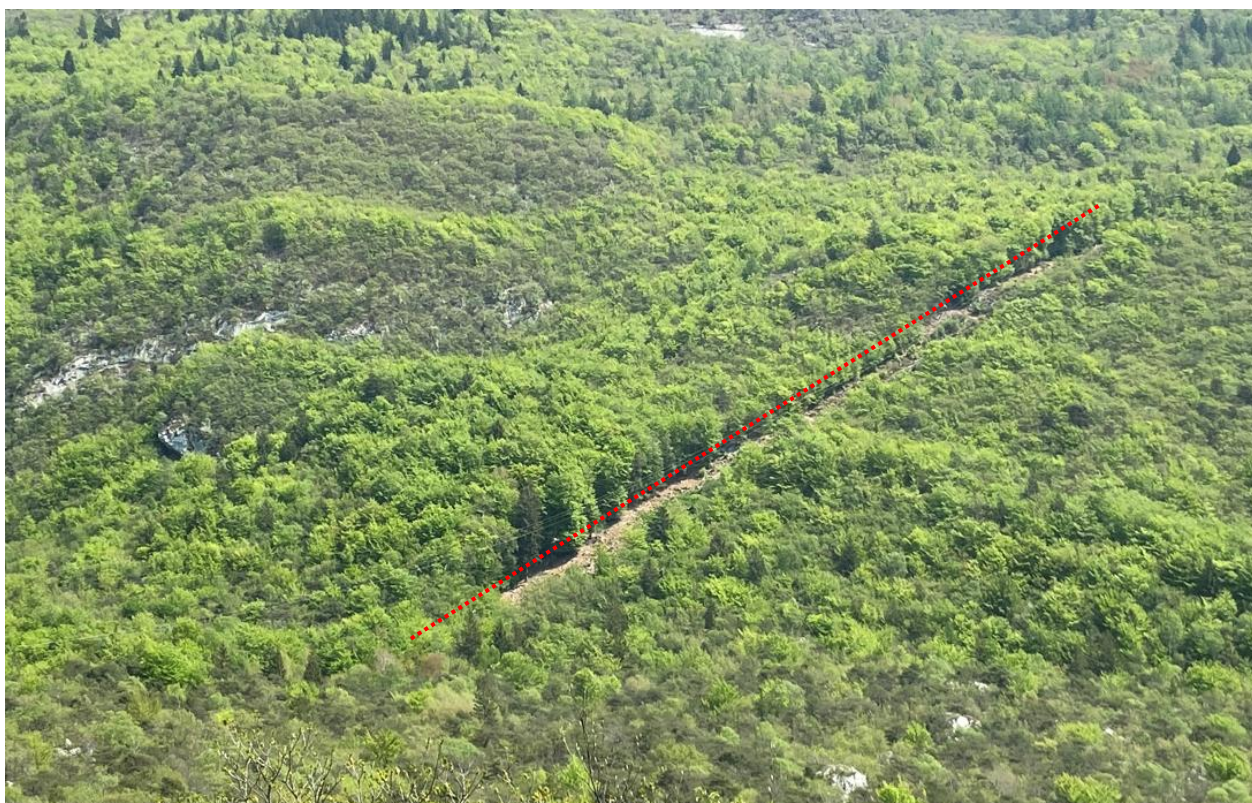
Figura 37: fascia sotto linea priva di vegetazione in relazione a una linea elettrica con soluzione “bassa” – vista laterale
