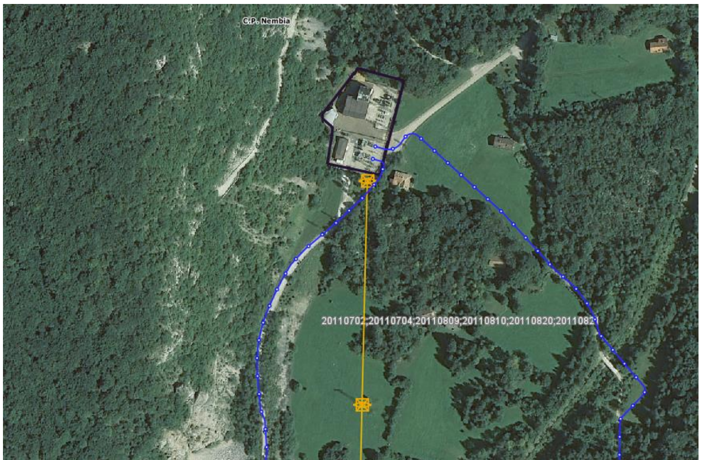
Figura 30 – Veduta aerea (volo PNG 2012) dell'area della CP di Nembia interessata dalla realizzazione del cavidotto interrato in progetto e dalla demolizione della linea aerea esistente
