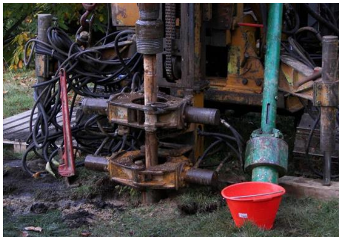
Figura 17: Macchina operatrice per la realizzazione di micropali tubfix. A sinistra sistema di scavo a rotopercussione, a destra sistema di scavo mediante trivella elicoidale.
