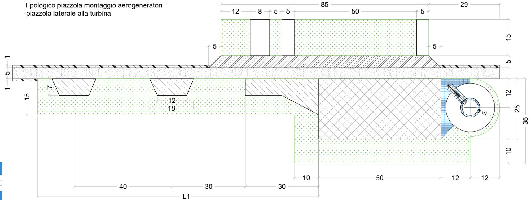
Tipologico piazzola montaggio aerogeneratori
